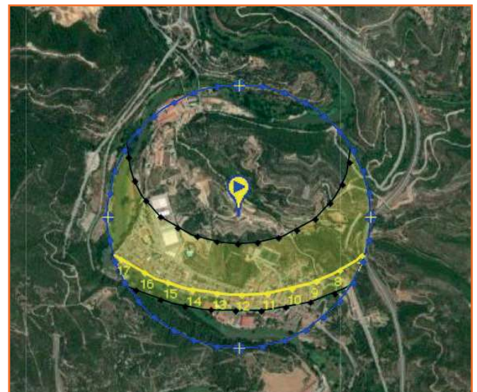
FIGURA 07: Posición del Sol para distintas horas desde la plaza de la iglesia de Santa Maria del Vilar. Fuente: https://www.sunearthtools.com/dp/tools/pos_sun.php?lang=es .
