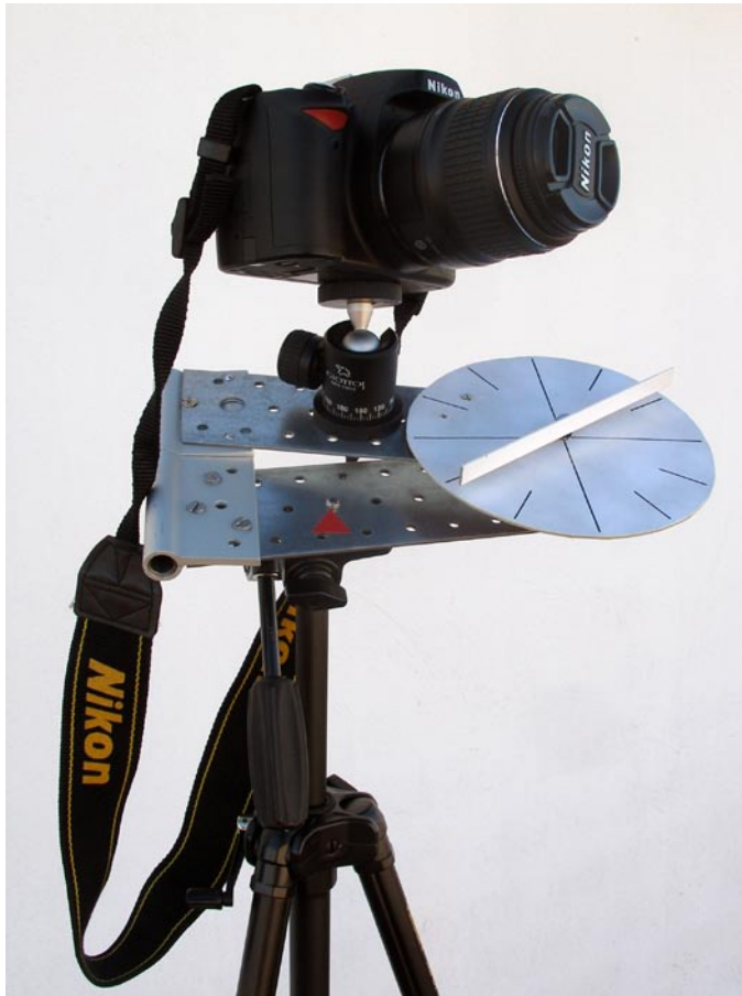
Fig. 6: CÁMARA SOBRE LA MONTURA CASERA
