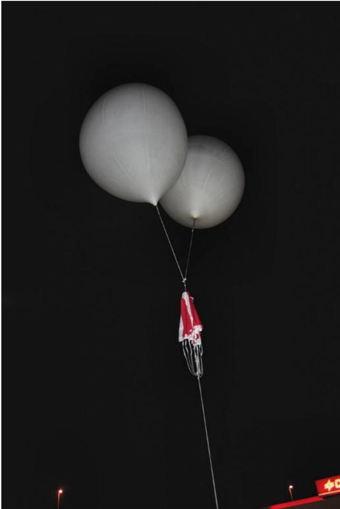
FOTO 7.- ASPECTO QUE OFRECÍA EL CONJUNTO DEL SISTEMA DE ELEVACIÓN DE LA SONDA. MOMENTOS ANTES DEL LANZAMIENTO. EN TOTAL ERAN UNOS 6 M. DE ALTURA DESDE LOS GLOBOS, HASTA LA BASE DE LA SONDA.
