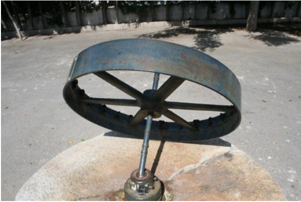
Reloj del polideportivo. El primero de OTOS. OBSERSE LA SOMBRA DEL EQUINOCCIO, QUE CAE JUSTAMENTE SOBRE LA SEÑAL SITUADA JUNTO AL EJE DE LA "RUEDA". EL GNOMON QUEDA ILUMINADO PRÁCTICAMENTE EN SU TOTALIDAD.
