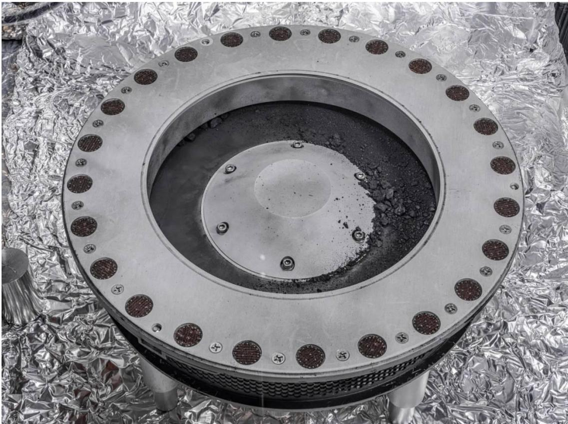
*Fotografía cedida por la NASA de una vista del exterior del recolector de muestras de Osiris-Rex donde se puede ver, en el centro (a la derecha de la imagen), parte del material traído como muestra del asteroide Benu. / EFE/NASA/Erika Blumenfeld & Joseph Aebersold.*
